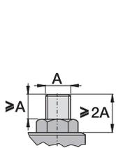
Minimum Stud Protrusion
